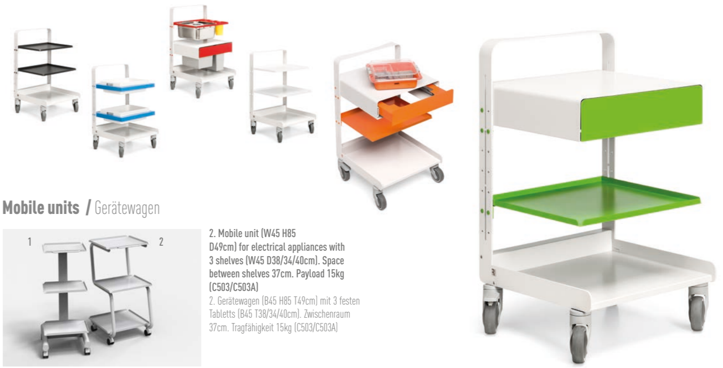
1. Mobile unit (W38 H85 D43cm) for electrical appliances with 3 shelves (W38 D32/29cm) Space between shelves 31cm. Payload 15kg (C502/C502A) 1. Gerätewagen (B38 H85 T43cm) mit 3 festen Tabletts (B38 T32/29) Zwischenraum 31cm. Tragfähigkeit 15kg (C502/C502A)
